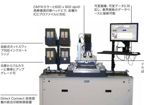
インテリジェントな印刷送 り装置が縦に動き、厚みが ばらつく郵便物にも対応
